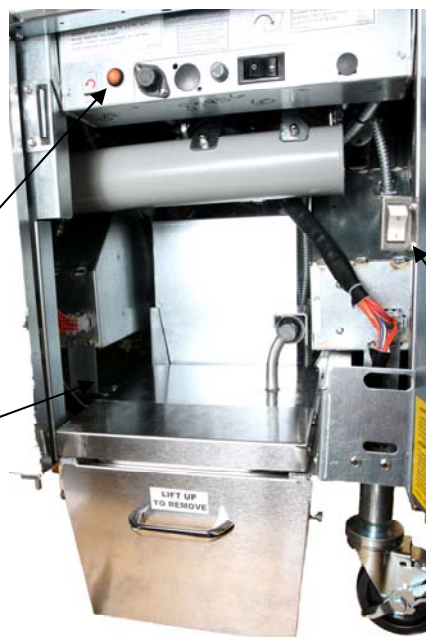
Figure 3: Enchufe los conectores blancos de dos patillas y enchufe el conector negro en la caja de suministro eléctrico tal y como se muestra en la ilustración.
